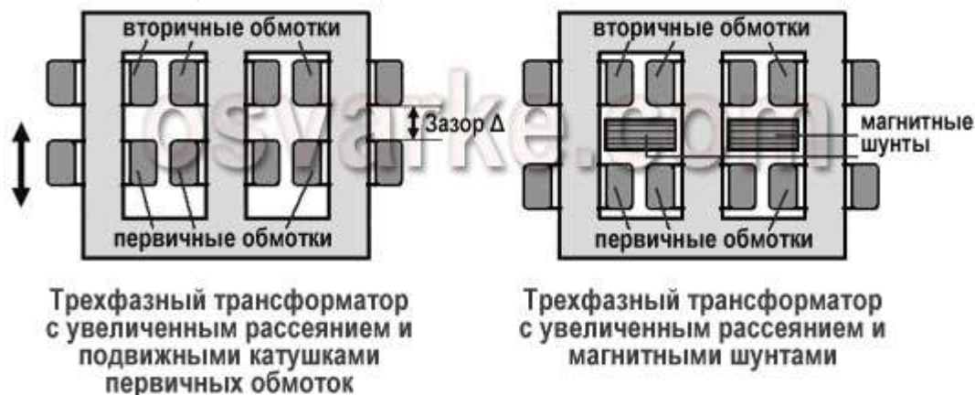
Рис.20 Трехфазные трансформаторы с подвижными обмотками и магнитными шунтами
