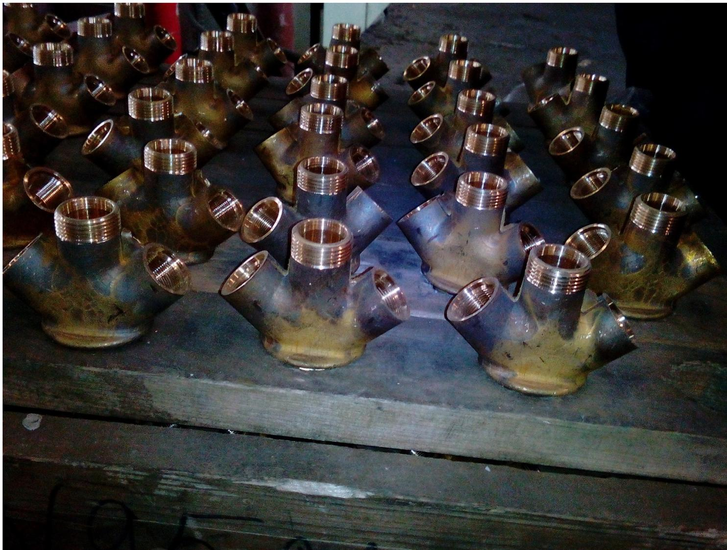
Это еще не отшлифованные латунные детали смесителя. Далее они пройдут шлифовку, полировку, а потом все детали поступают на определенный конвейер и собираются в готовый смеситель.
