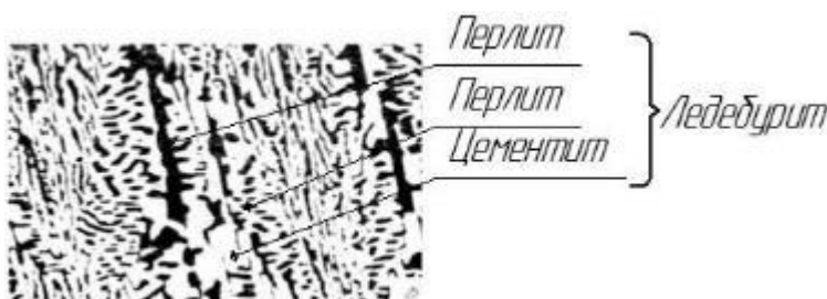
Рис. 10 Структура эвтектического чугуна, X500
