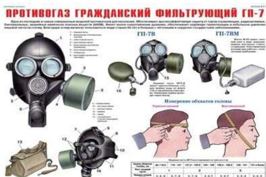
*Фильтрующие противогазы* являются основным средством индивидуальной защиты органов дыхания. Принцип их защитного действия основан на предварительном очищении (фильтрации) вдыхаемого человеком воздуха через фильтры от различных вредных примесей. В настоящее время в системе гражданской обороны для взрослого населения используются фильтрующие противогазы ГП-7, ГП-5, ГП-5м и ГП-4у.
