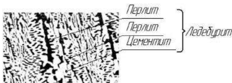
Рис. 10 Структура эвтектического чугуна, X500
