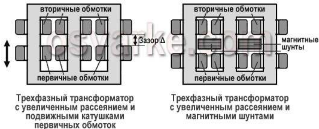
Рис.16 Трехфазные трансформаторы с подвижными обмотками и магнитными шунтами
