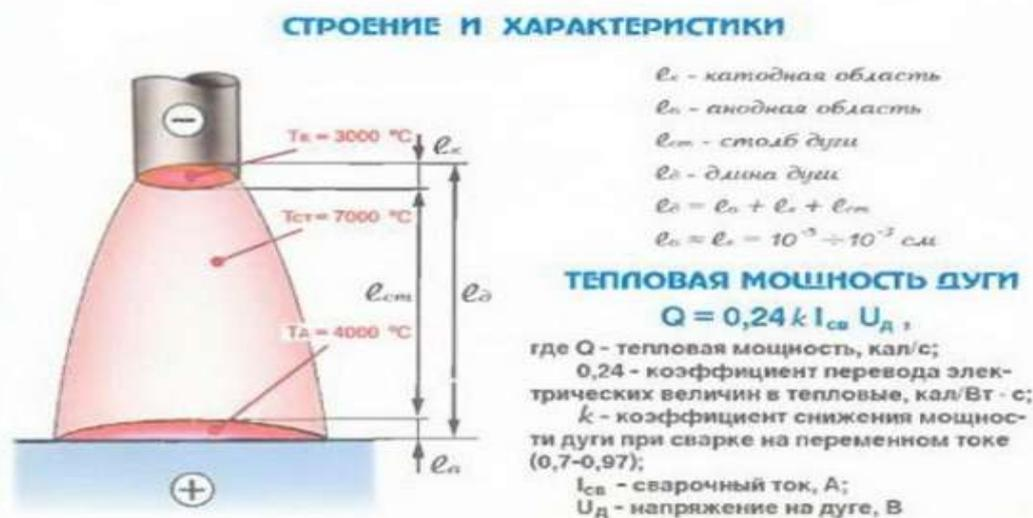
Рис.2 Строение сварочной дуги.
