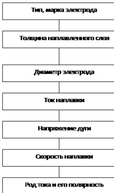
Рис.4 Основные параметры процесса ручной дуговой наплавки
