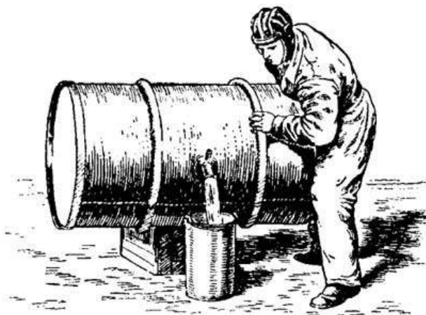
Рисунок 1. Сплав горючего из бочки при помощи специальной сливной пробки
