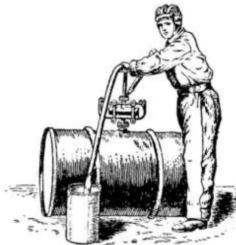
Рисунок 2. Перекачка горючего из бочки при помощи ручного насоса Гарда
